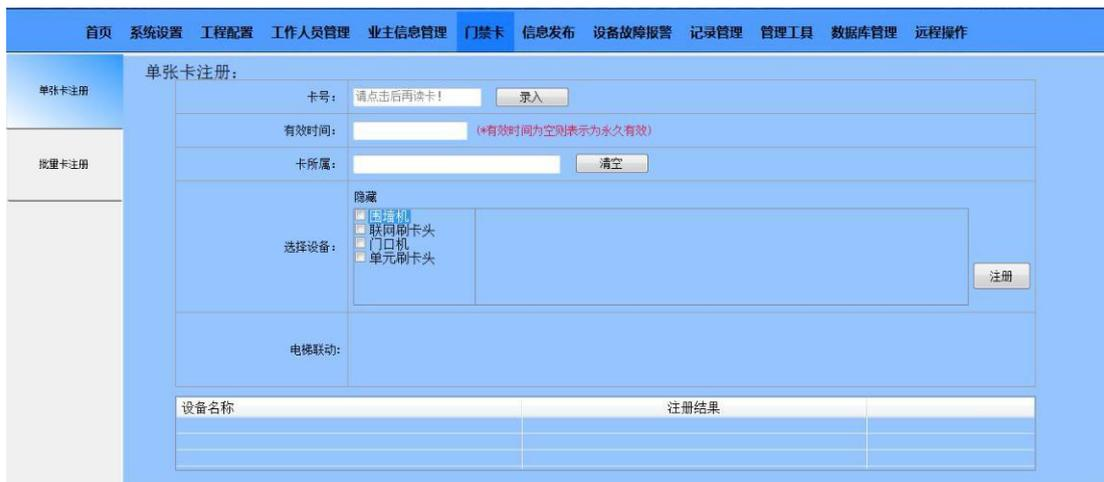
门禁卡录入方式有：手动录入卡号或发卡器刷卡录入（需选择刷卡器连接的电脑 COM 口）。
